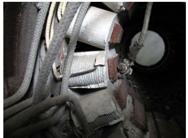
Abb. 6: Hochtemperatur-Radialmagnetlager mit Keramikisolation
