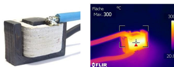
Abbildung 8: gedruckte Spule auf ebenfalls gedrucktem Magnetkreis (links), Wärmebild der Anordnung im Test bei Dauerstrom i = 80 \text{ ADC}
