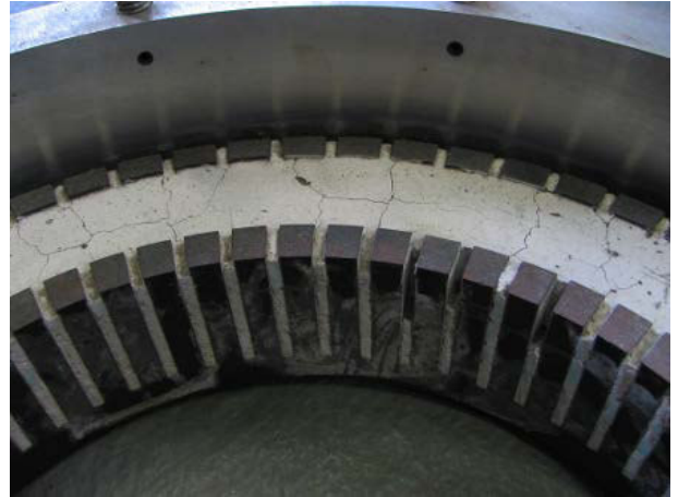
Abb. 4: Axialmagnetlager mit keramischer Isolation
